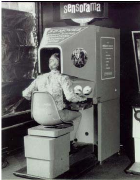
Morton Heilig, Sensorama Machine, 1962 Cabine individuelle qui permet de visionner des films en reliefs, auxquels sont ajoutés des vibrations, des odeurs, des courants d'air
