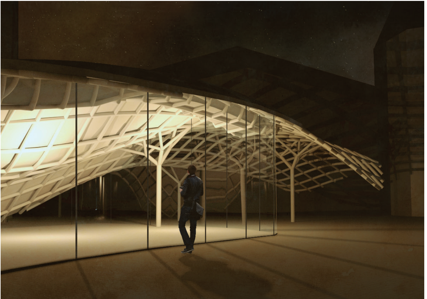
FIG 10 | Windoor Garden. Projet de jardin d'hiver public prenant la forme d'un maillage, dont les deux faces sont accessibles. Grasshopper nous a permis de concevoir précisément les passages, l'accessibilité des dispositifs publics pour rendre la toiture accessible et praticable. Le design du maillage et des poteaux ont également été réalisés sur Grasshopper et Rhinoceros 3D. Source : Projet de groupe réalisé au cours du semestre 7.
