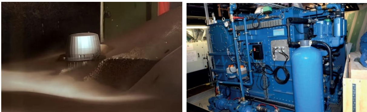
Figure 47 : Etude en soufflerie pour le fondoir à neige et unité de traitement de l'eau
