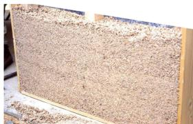
Utilisation du béton de chanvre pour l'isolation du bâtiment existant.
