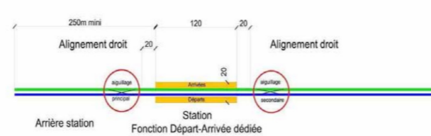
n°2 : Station avec "2 quais latéraux - 2 voies"
